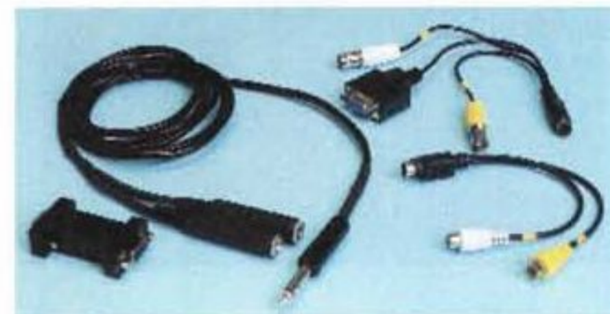
Nella dotazione della 1212 I/O troviamo tutto il necessario per la connessione a dispositivi audio esterni, con cavetti per gli ingressi e le uscite analogiche e digitali, e quelli per la sincronizzazione con dispositivi di registrazione esterni tipo ADAT.
