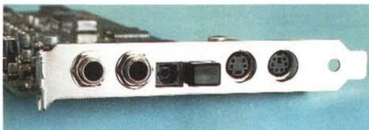
La scheda Korg presenta una nutrita serie di connettori: abbiamo due coppie di ingressi ed una uscita stereo, una analogica ed una digitale S/PDIF, più una coppia ingresso/uscita ottici in standard ADAT ed una presa per il collegamento a dispositivi di sincronizzazione esterni.
