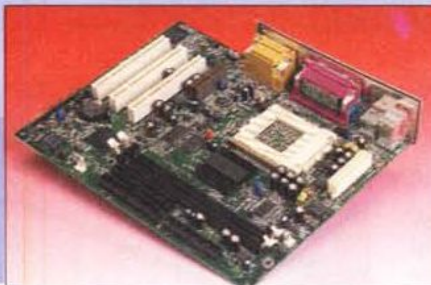
La scheda madre QDI Winnex per il Socket 370 del Celeron (L. 195.000 + IVA) è dotata del chipset 810 di Intel, ed integra l'interfaccia video e il controller UltraATA-66. Il BIOS della M/B controlla completamente la scheda, che quindi è completamente "jumpless". La M/B QDI Superb 1 (L. 130.000 + IVA) con Super Socket 7 (non illustrata) è dotata di chipset SIS 530 e adattatore video integrato.
