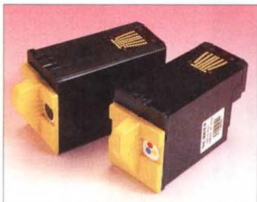
Le nuove cartucce integrano i contatti della testina di stampa e sono caratterizzate da una notevole capacità.
