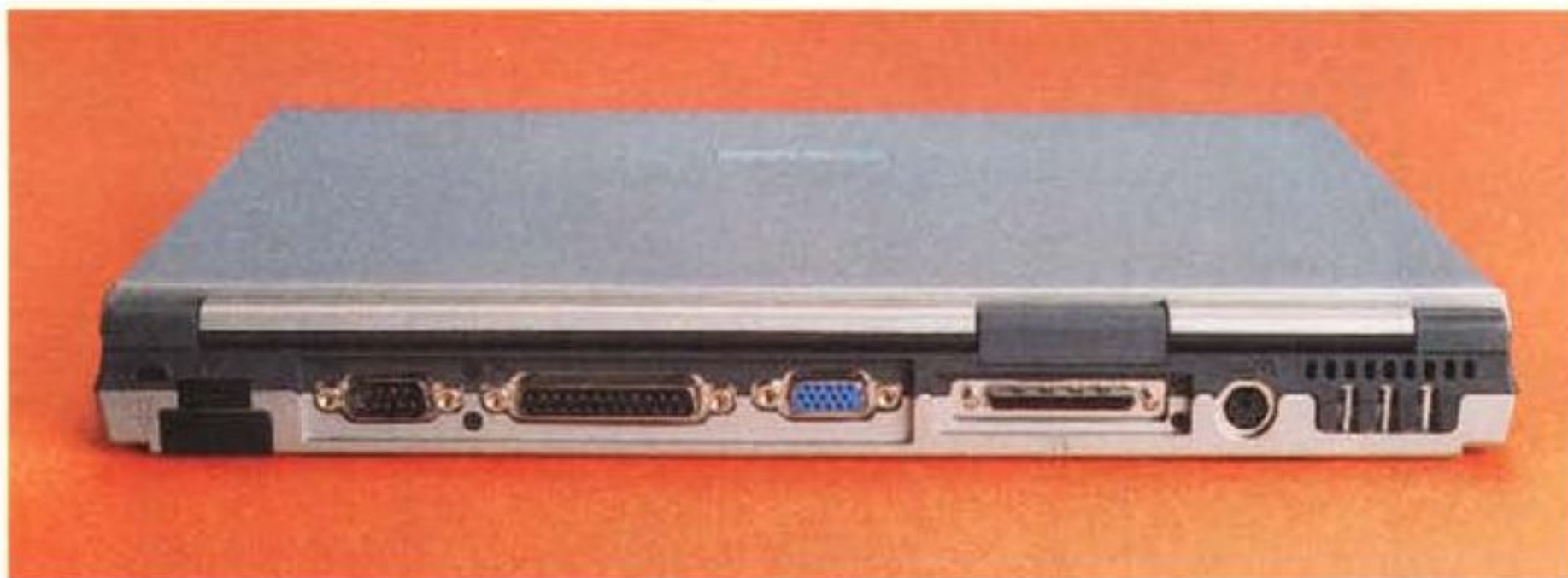
Le connessioni disponibili sul pannello posteriore comprendono porta seriale, porta parallela standard EPP/ECP, porta infrarossi, connettore per monitor esterno e connettore PortDock per la Docking Station. Trattandosi di un esemplare di preserie, il modello in prova non incorpora il modem V90, che verrà invece fornito di serie.
