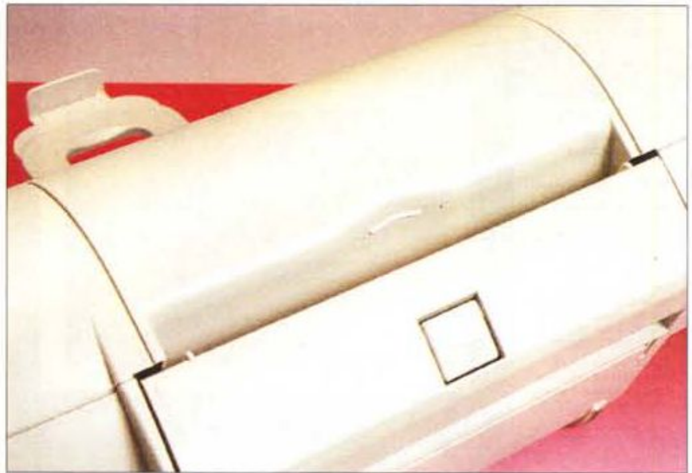
Il terzo introduttore funziona manualmente e risulta molto comodo per documenti che sfruttino diversi formati di carta per le varie pagine. Un pulsante ne facilita l'apertura, così da poter liberare il trattore da fogli che dovessero eventualmente incepparsi.
