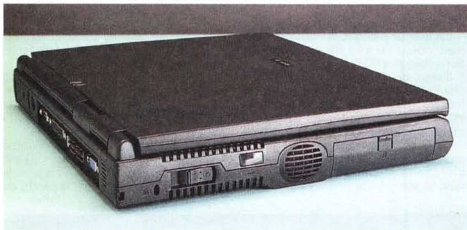
Lato sinistro del notebook: da sinistra, l'interruttore di alimentazione, la finestra per le comunicazioni IrDA, la griglia per la ventolina di raffreddamento e lo sportellino per l'accesso alla batteria principale.
