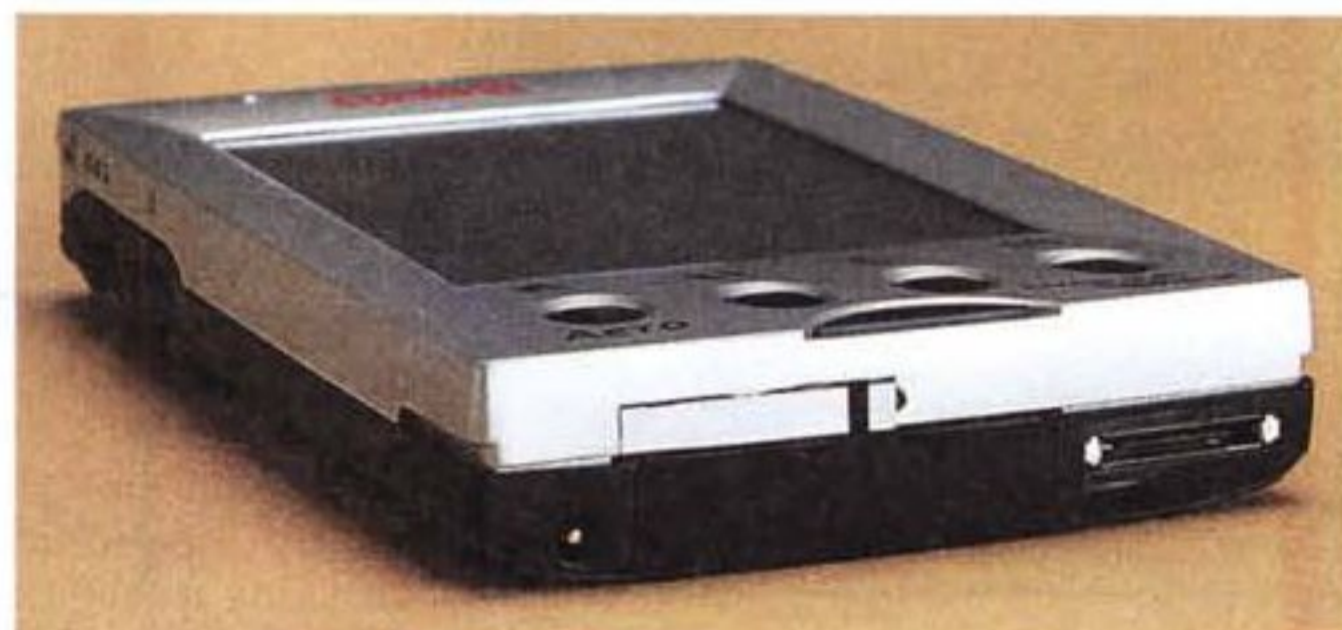
Lato inferiore: a sinistra l'ingresso per l'alimentazione, il vano per la batteria di backup e a destra il connettore per le comunicazioni con il PC desktop.
