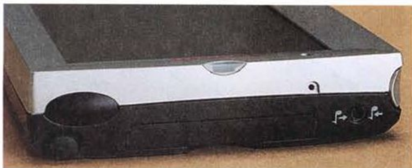
Lato superiore: a sinistra si nota, incassato, lo stilo e la finestra ellittica per le comunicazioni IrDa; al centro è posto lo slot per le schede CompactFlash e il LED di stato, e a destra troviamo il forellino per il microfono, il pin-jack da 2,5 mm per l'auricolare/microfono in dotazione e il tastino REC.
