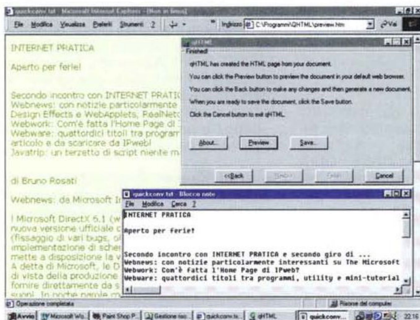
Fig.13 - QuickHTML mentre legge il file .txt, lo traduce tramite i suoi Wizard e quindi lo pubblica come una normale pagina HTML.
