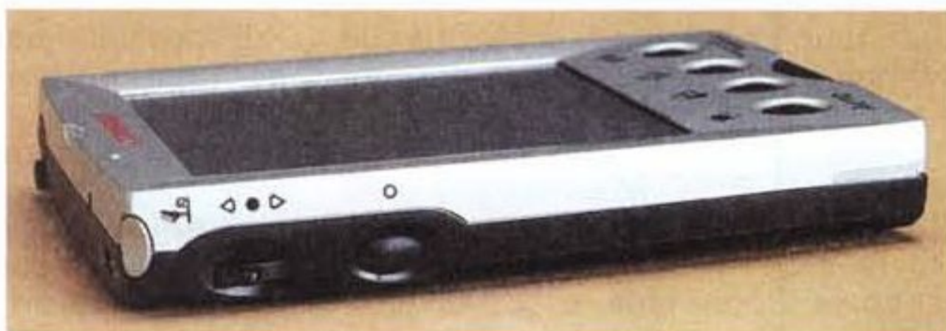
Lato sinistro: la rotellina di scrolling e il tasto ESC; sullo spigolo in alto è visibile il tasto per la registrazione rapida.
