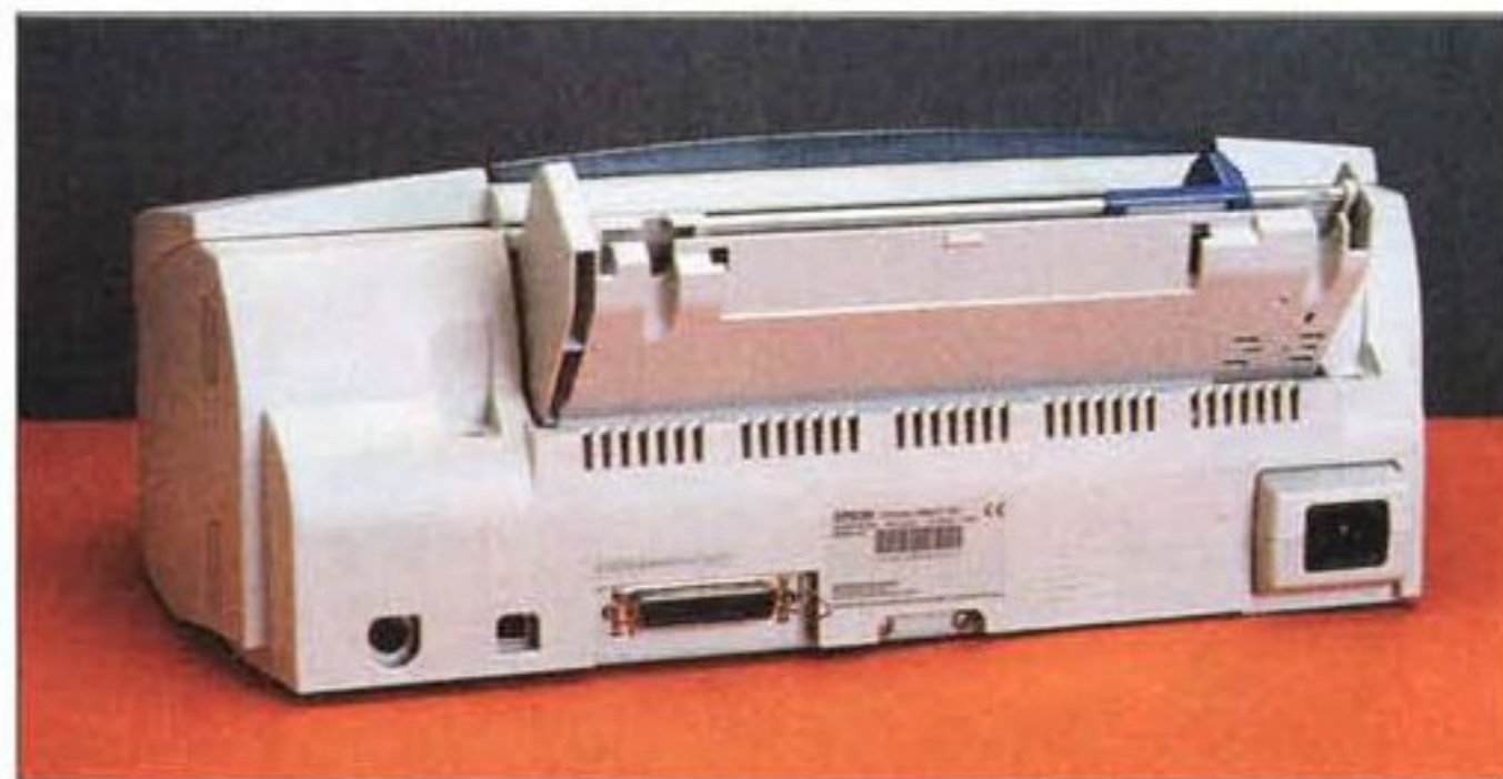
Sono visibili le tre interfacce di questa EPSON: parallela, seriale e USB.
