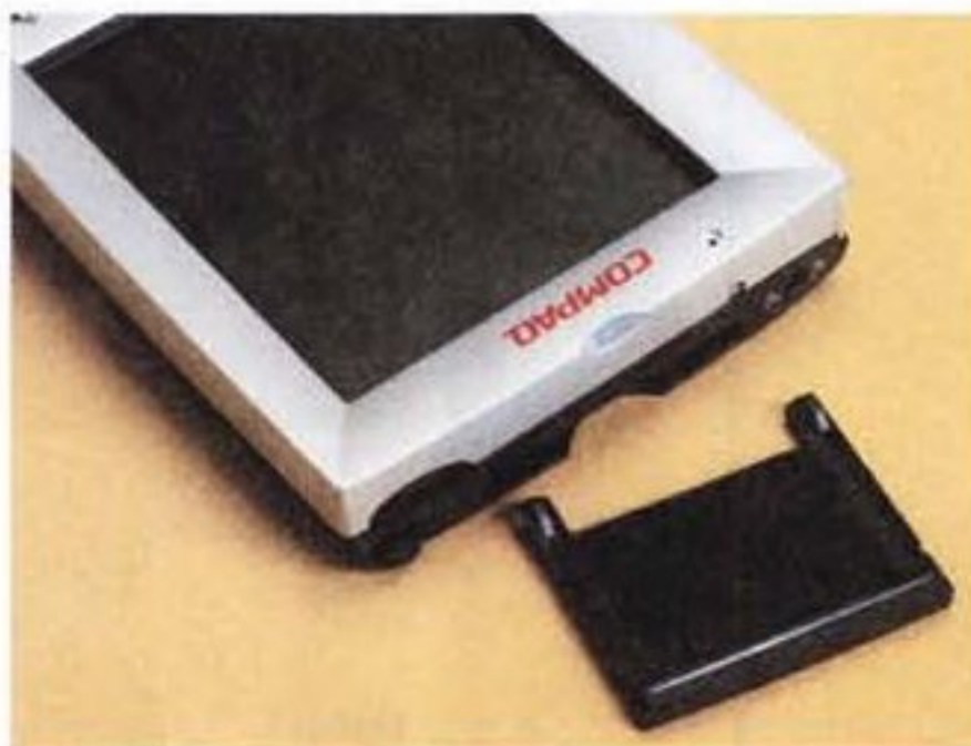
Il vano per le CompactFlash. Sono state annunciate una serie di opzioni e espansioni compatibili con questo standard, oltre ai modem saranno disponibili a breve schede di rete da 10 Mbit, memorie Flash di capacità superiore, cercapersone, Barcode reader e altro...
