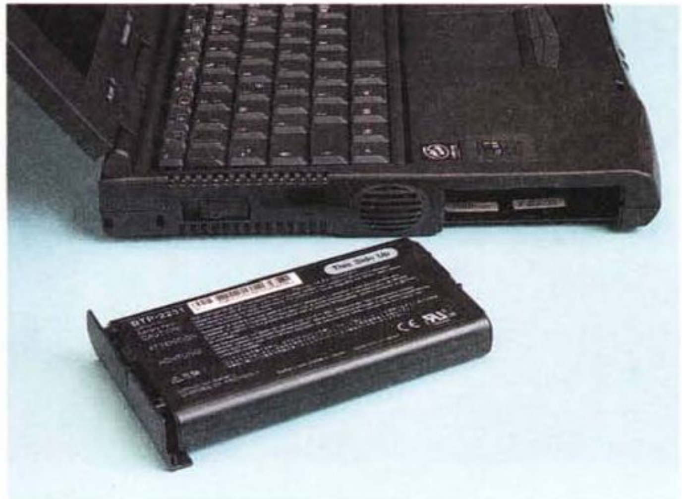
Particolare della batteria agli ioni di litio; consente un'autonomia di oltre cinque ore di ascolto continuato (a PC spento).
