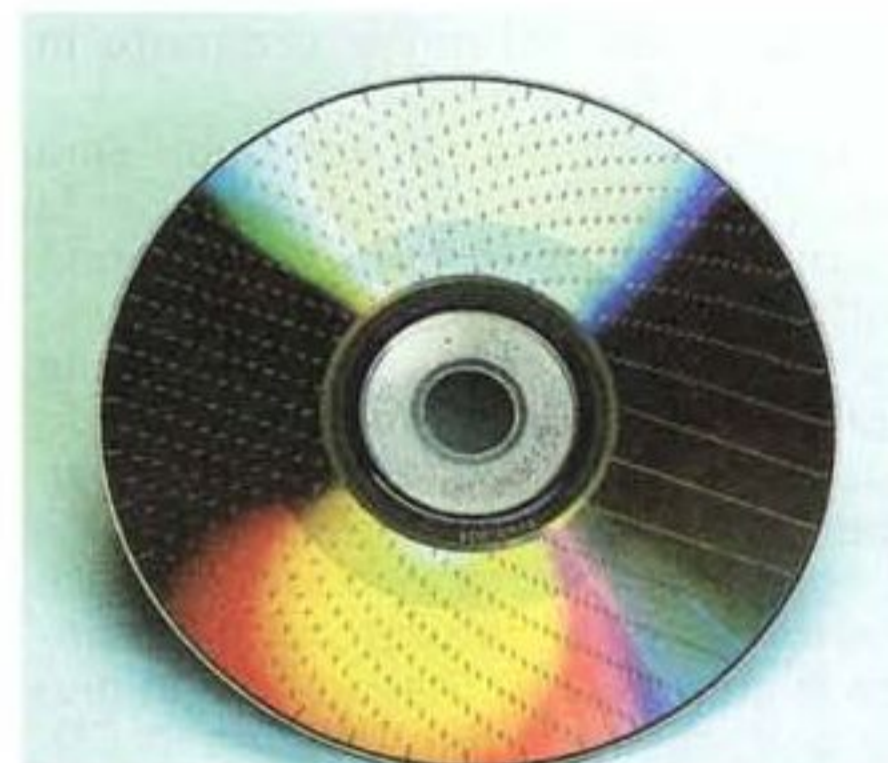
Una volta estratto, il disco DVD-RAM si presenta del tutto simile ad un CD-ROM, se non fosse per la presenza dei "segni" lasciati dalla formattazione fisica: una serie di suddivisioni su tutta la superficie, che dividono il DVD in blocchi di ampiezza costante di 2048 byte.
