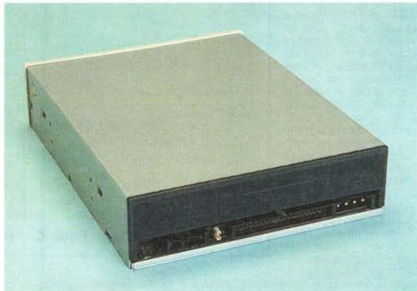
Il lettore DVD-ROM è una classica meccanica con sportellino estraibile ed interfaccia EIDE. Da notare, sul pannello posteriore, la presenza dell'uscita audio digitale in standard S/PDIF.
