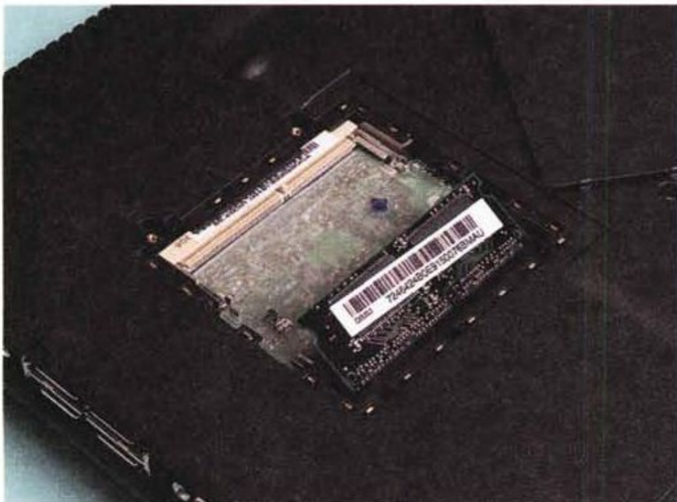
Particolare del vano per le espansioni della memoria RAM centrale. La DIMM installata è da 32 Mbyte; usando due DIMM da 128 Mbyte è possibile raggiungere la ragguardevole quantità di 256 Mbyte.
