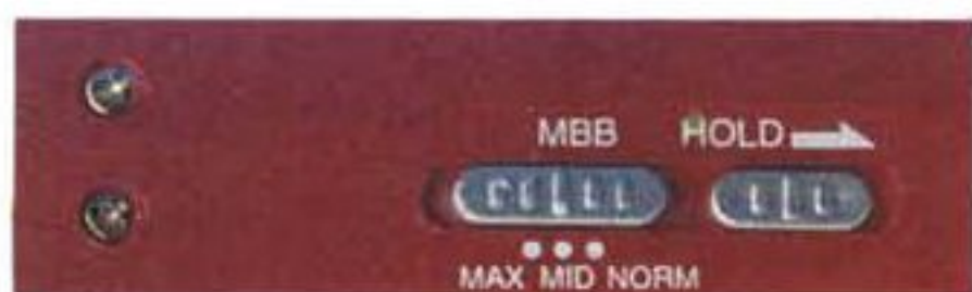
Lateralmente troviamo il controllo dell'equalizzazione, a tre posizioni, ed un interruttore che consente di bloccare il funzionamento dei tasti, utile quando si utilizza il lettore, ad esempio, mentre si fa jogging.
