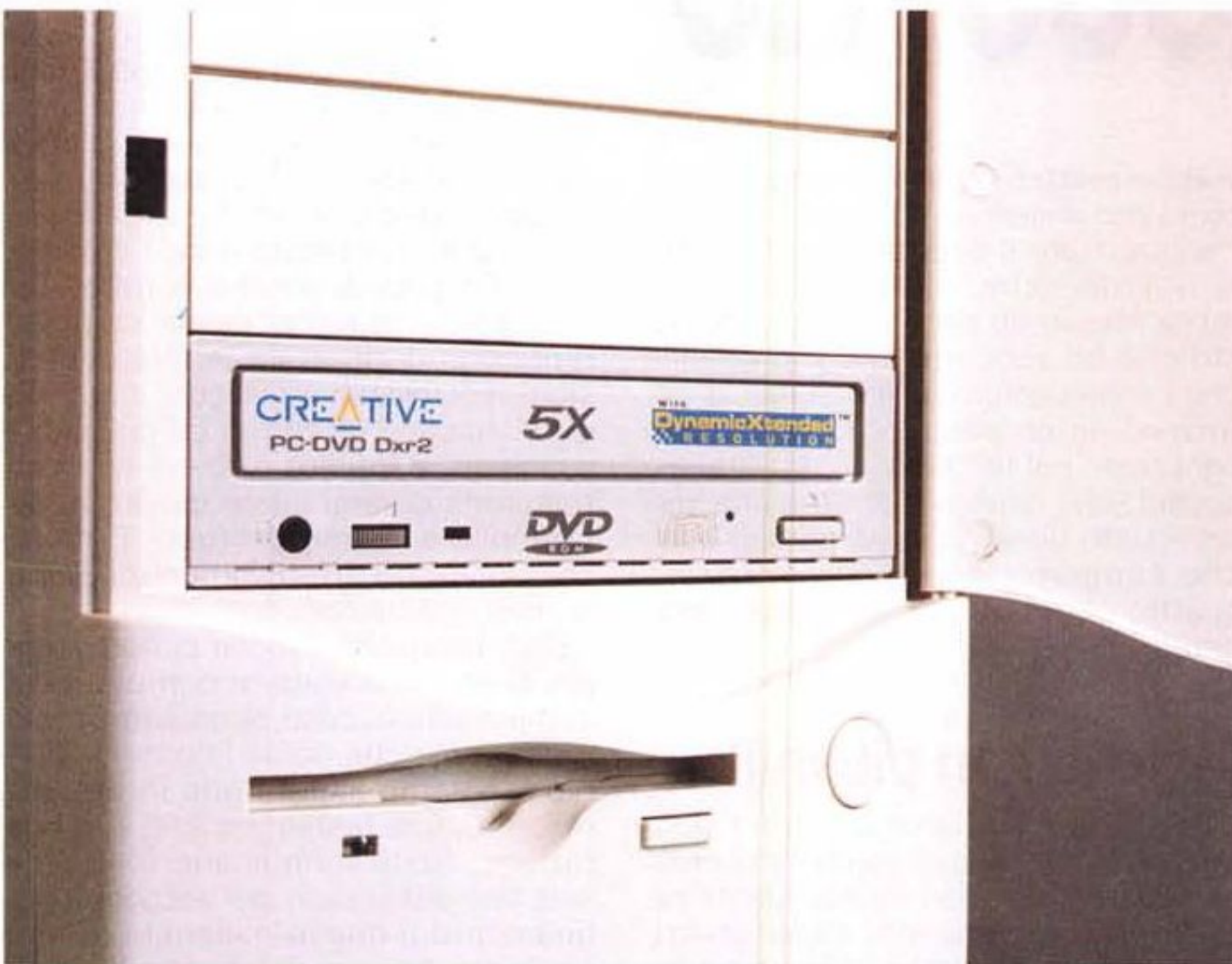
In primo piano l'ottimo lettore DVD creative e la fessura, integrata nel frontale, per l'inserimento del floppy. Quest'ultima, anche se esteticamente gradevole, risulta scomoda per l'estrazione del dischetto.
