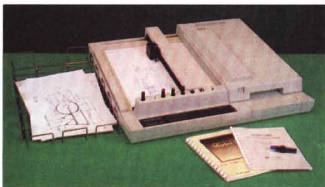
Il CalComp M83 era un plotter a colori formato A3 con capacità di digitizer. Aveva 8 penne, un alimentatore automatico per i fogli e una velocità di tracciamento di tutto rispetto.
