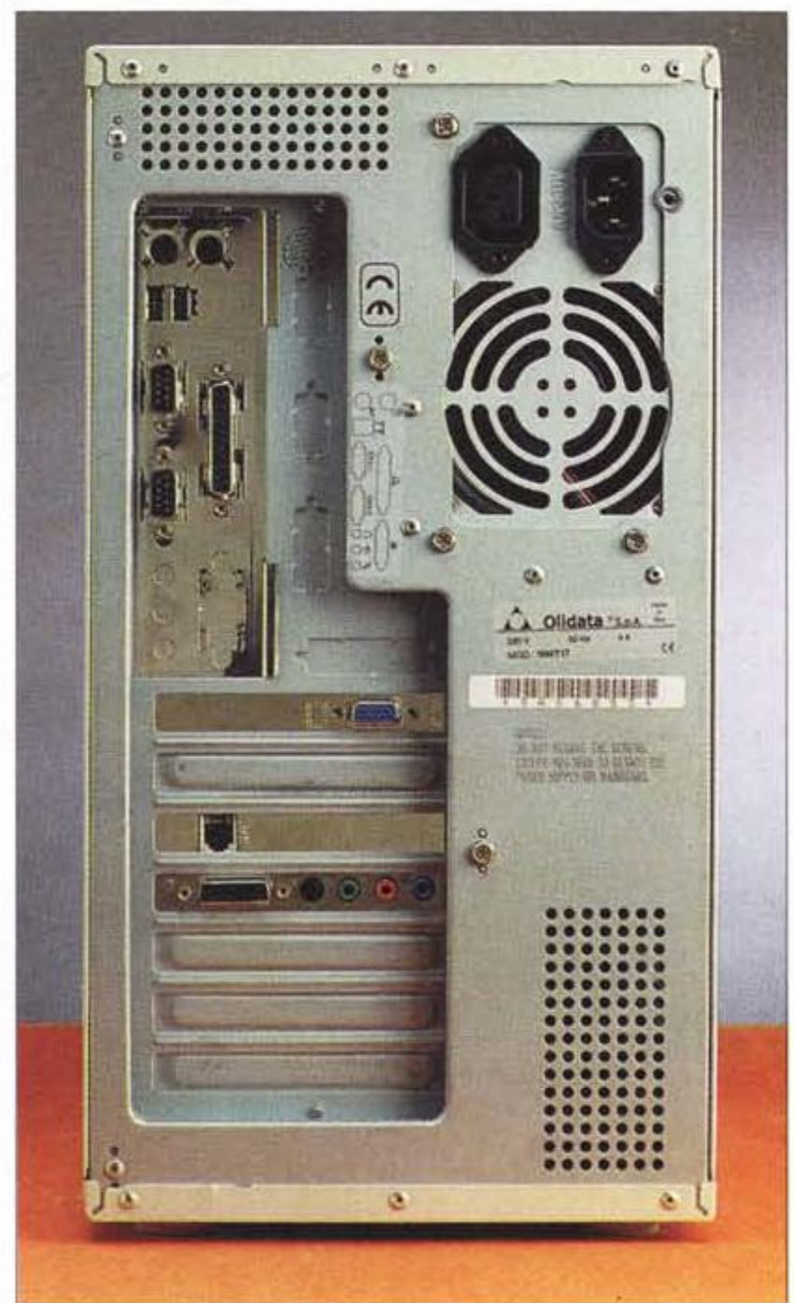
Il retro: nulla da dire, fin qui si tratta di una classica macchina ATX; notare comunque la presenza di una presa pilotata sul retro dell'alimentatore.
