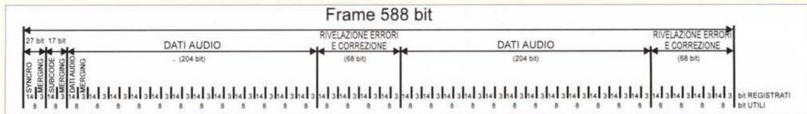
Figura A - L'interleaving disperde i dati di campioni adiacenti ed evita così la perdita di larghe fette di segnale nel caso di errore di lettura.
