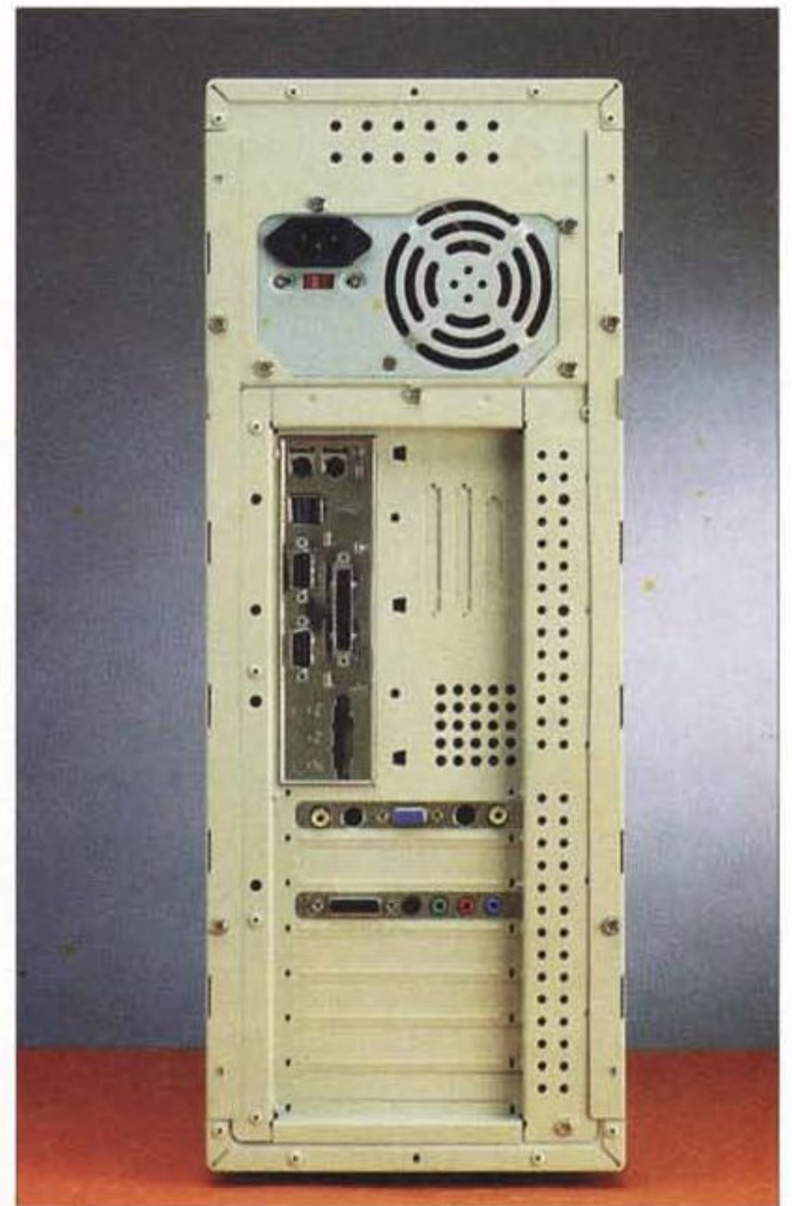
Sul retro della macchina troviamo i consueti connettori per mouse, tastiera, alimentazione, eccetera; da notare i connettori per le entrate ed uscite video sull'acceleratore grafico. È anche possibile utilizzare le forature pretagliate per accomodare i connettori "half-pitch" del controller U2SCSI Wide integrato su M/B.
