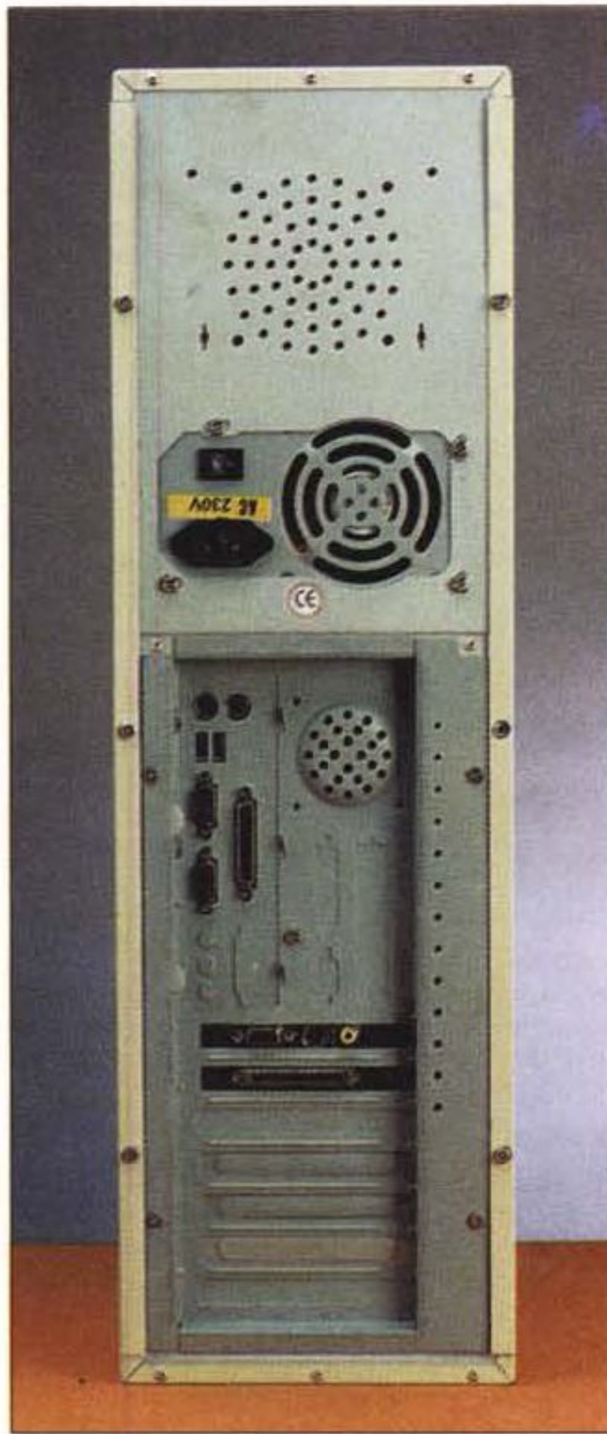
Sul retro è riportata una connessione alla catena SCSI in modo da permettere la connessione al bus di periferiche esterne.
