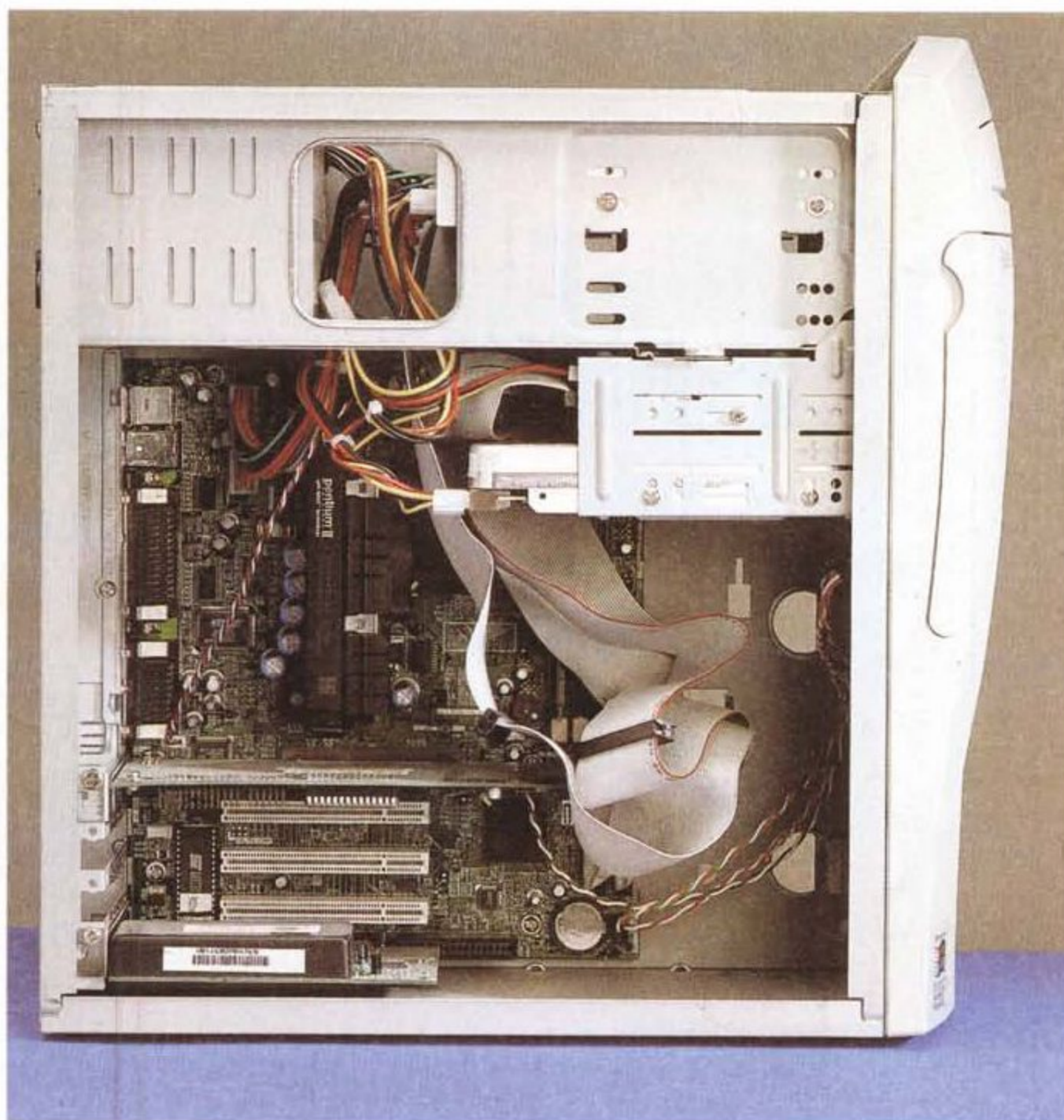
L'interno della macchina: non è ordinatissima, a prima vista sembrerebbe un prodotto OEM; l'accessibilità potrebbe essere migliore, ma d'altronde le dimensioni del minitower non permettono grandi cose... L'espandibilità della macchina è ottima, tutti gli slot PCI sono liberi, ed è anche disponibile un vano da 5", accessibile dall'esterno, attraverso lo sportellino che copre anche il floppy.
