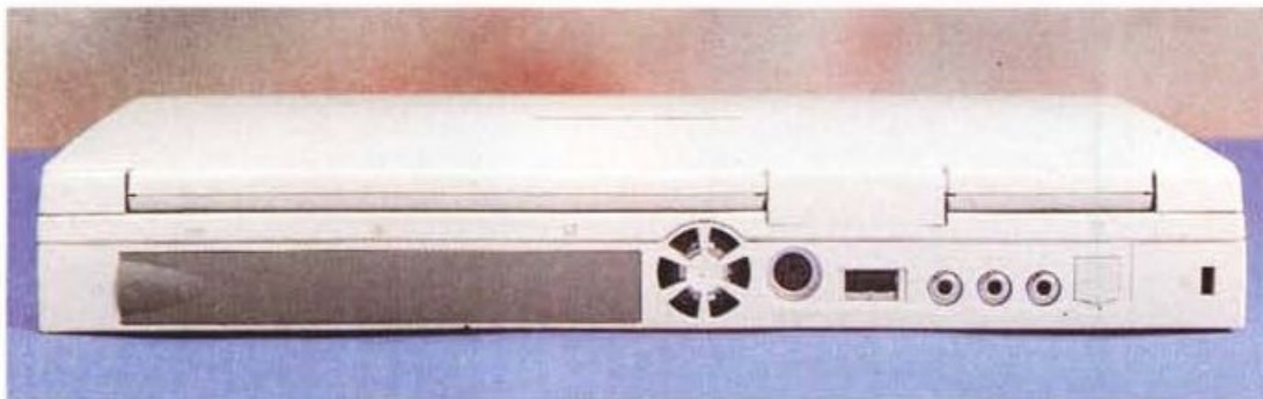
Il retro del computer diviso a metà dalla grossa ventola di raffreddamento. A sinistra, dietro un tappo di gomma, ci sono le uscite tradizionali, a destra le porte ad accesso immediato come la USB, la porta PS2 e i jack audio.
