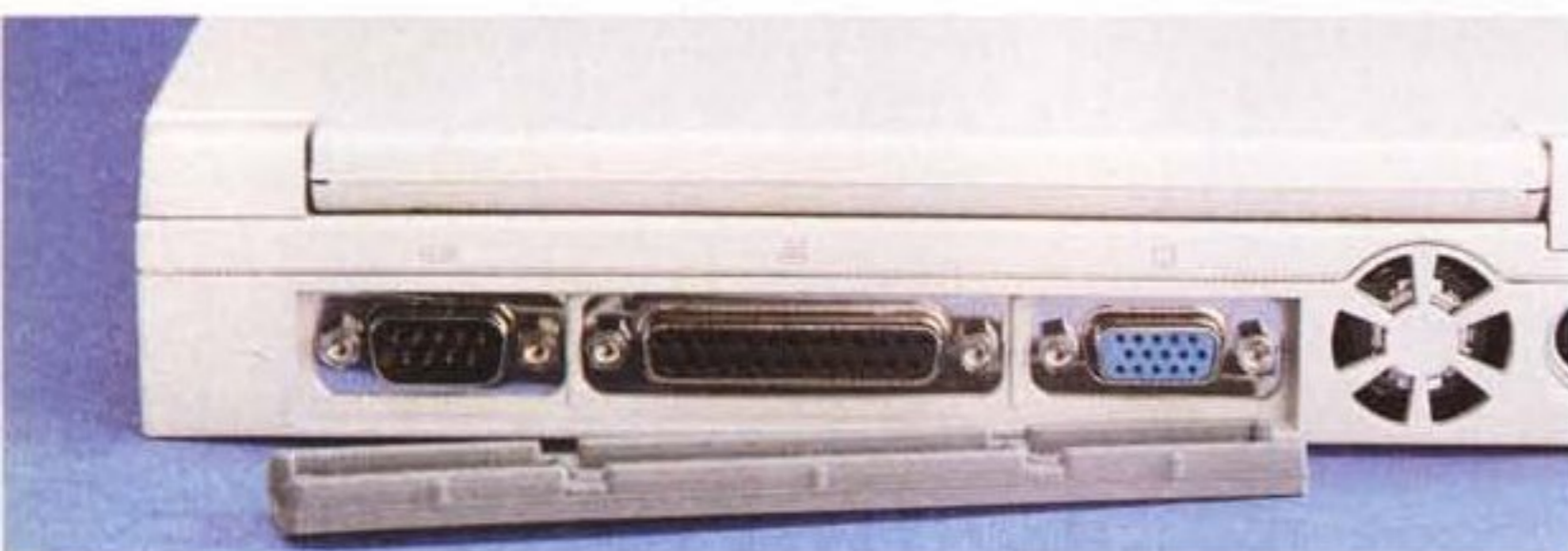
Il retro del computer diviso a metà dalla grossa ventola di raffreddamento. A sinistra, dietro un tappo di gomma, ci sono le uscite tradizionali, a destra le porte ad accesso immediato come la USB, la porta PS2 e i jack audio.
