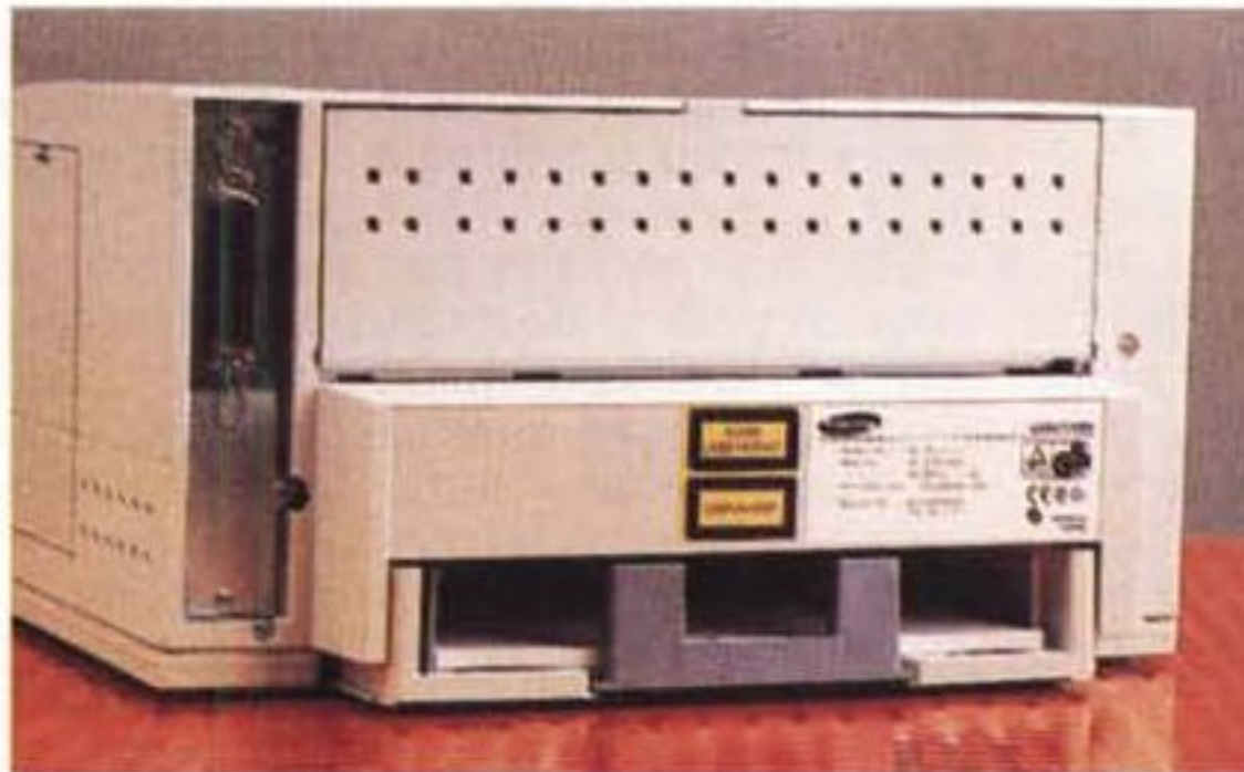
Il retro della stampante con il cassetto dell'interfaccia parallela e lo slot per l'opzione seriale chiuso da un coperchio. Il cassetto portafogli, regolabile per vari formati, può contenere 150 fogli.
