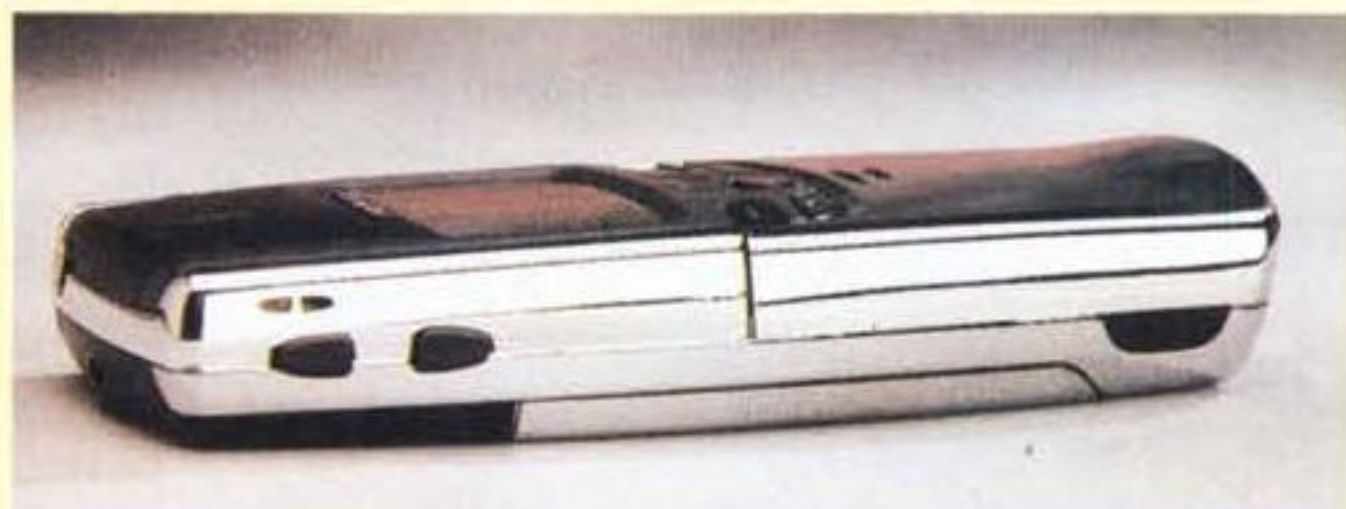
La porta IR dell'8810 è situata lateralmente e va attivata prima di ogni utilizzo
