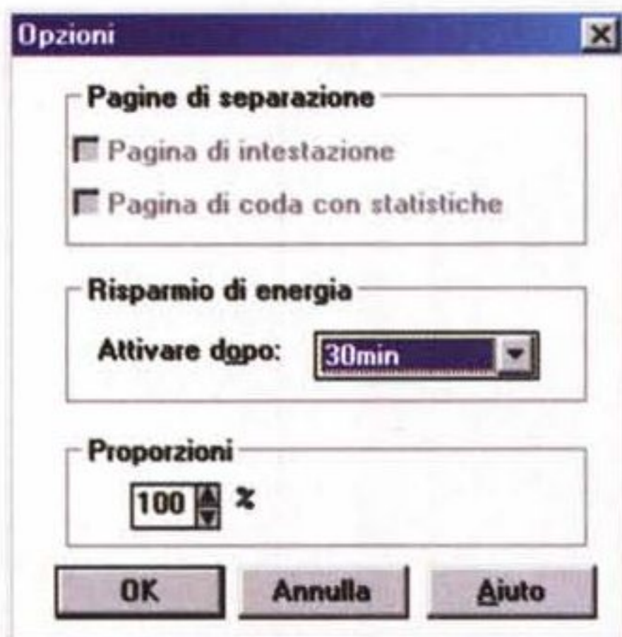
Il pannello di controllo del tempo di inattività che deve trascorrere prima che la stampante entri in stand-by.
