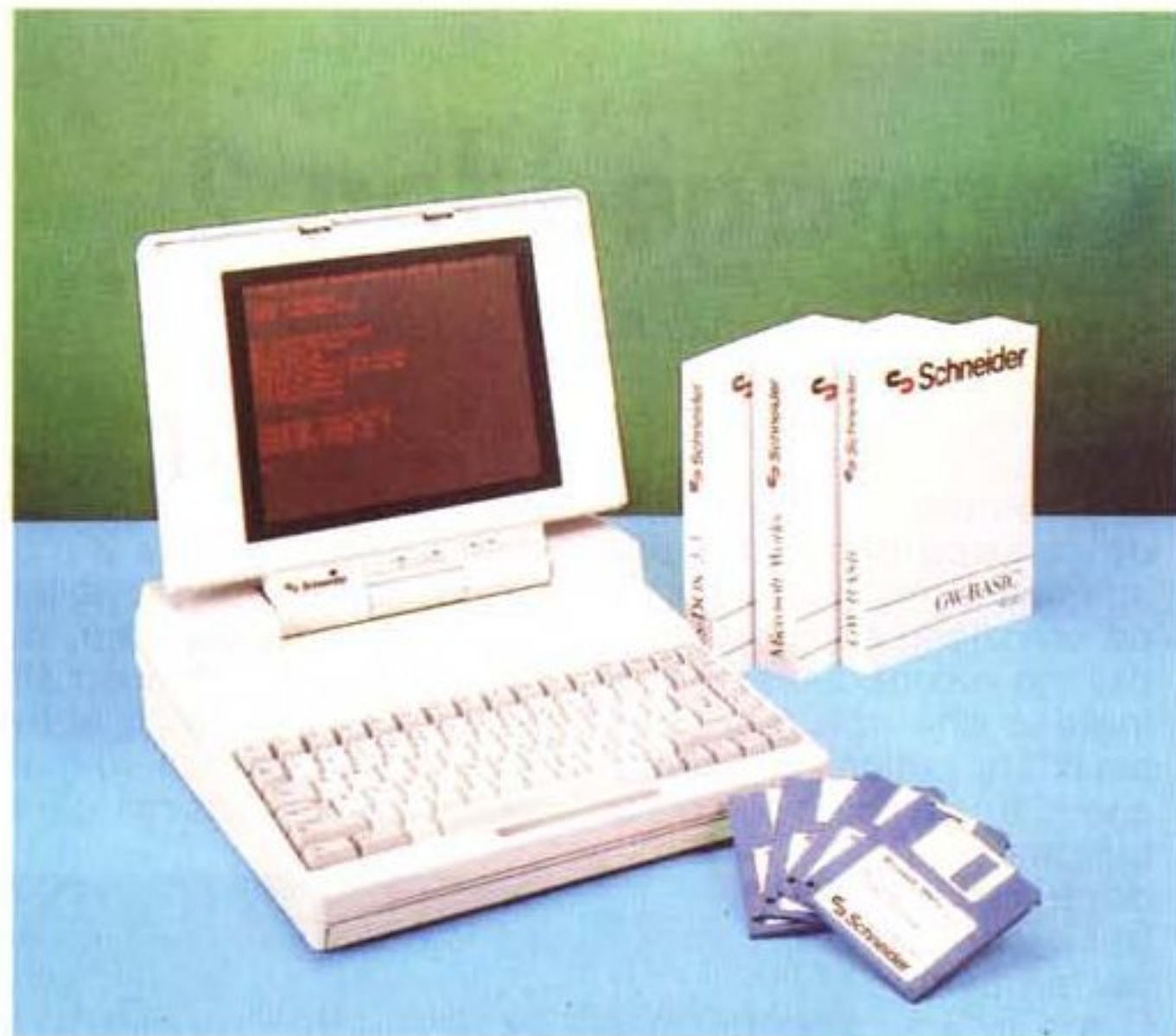
Schneider, chi era costui? Uno strano portatile, che però si alimenta solo dalla rete, con il cuore di un 286 e un avveniristico (e costoso) schermo al plasma.
