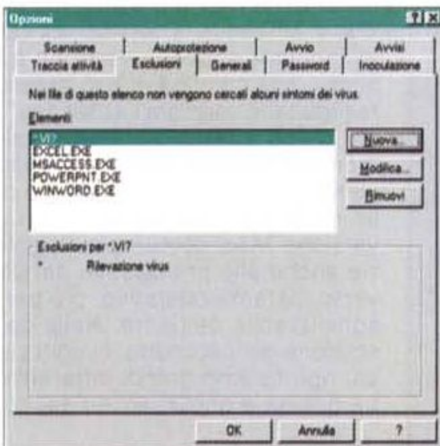
Alcune delle finestre di opzione disponibili; si noti come sia possibile disattivare l'autoprotezione, selezionare le aree di quarantena, escludere certi file dalla scansione, impostare password di protezione dei setup, eseguire operazioni di ricerca di inoculazione.
