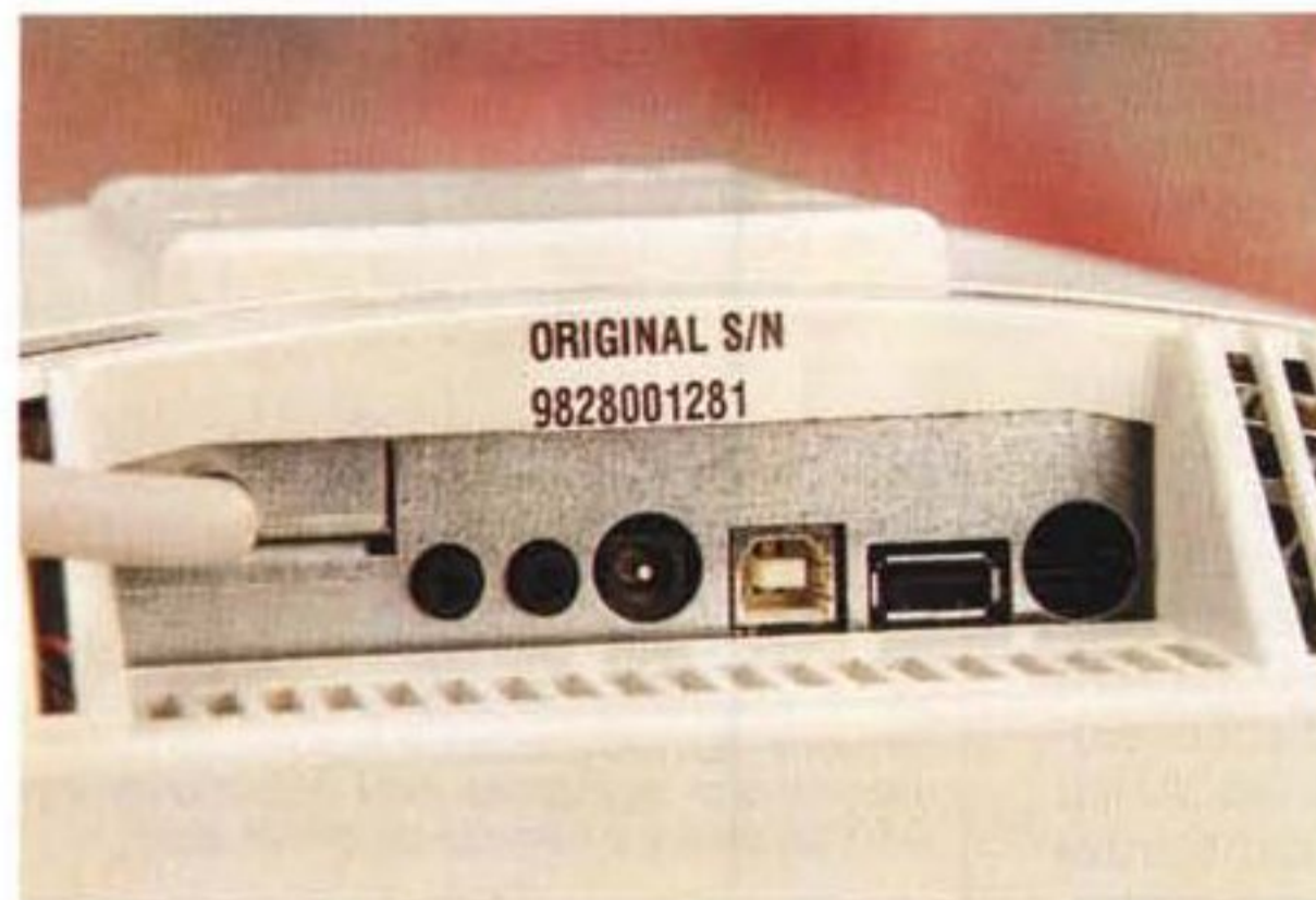
Il pannello delle connessioni è posizionato nella parte inferiore del telaio e comprende l'attacco per l'unità di alimentazione a corredo, i connettori del sistema audio integrato e le porte USB in ingresso ed in uscita: una periferica di tipo USB come mouse o tastiera può quindi utilizzare il monitor come hub.
