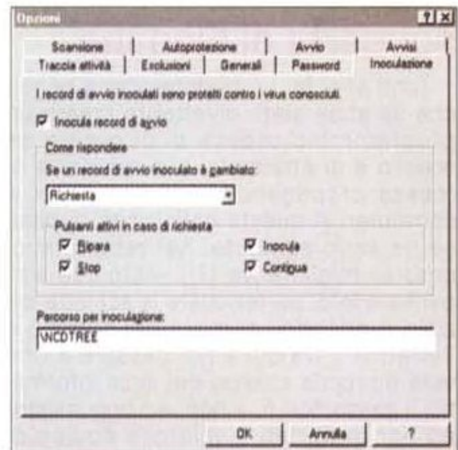
Alcune delle finestre di opzione disponibili; si noti come sia possibile disattivare l'autoprotezione, selezionare le aree di quarantena, escludere certi file dalla scansione, impostare password di protezione dei setup, eseguire operazioni di ricerca di inoculazione.
