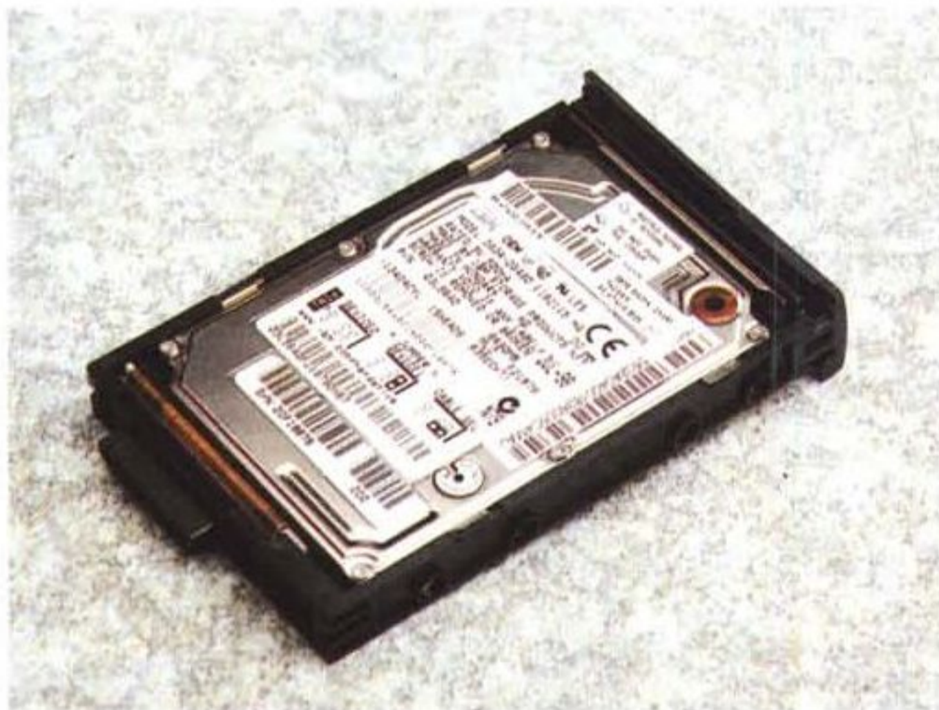
Il piccolissimo disco rigido interno della IBM non rivela, a prima vista, i suoi 6,4 GByte di capacità.
