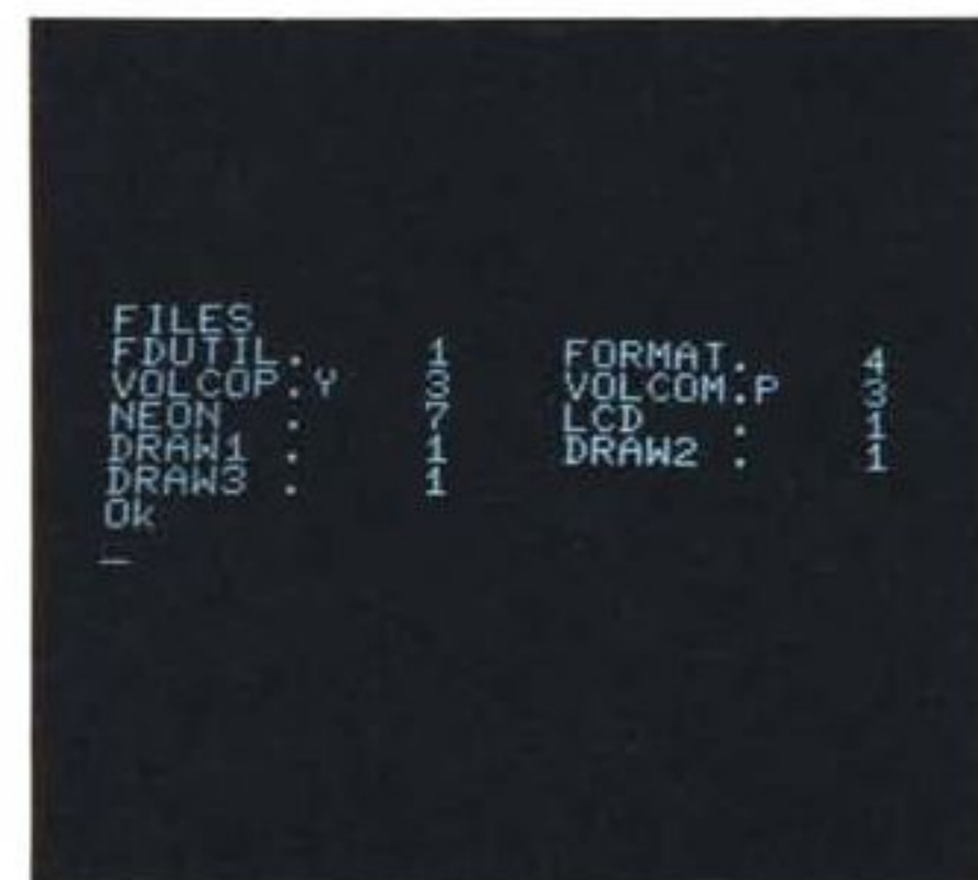
Le tre immagini del video mostrano il prompt del T-BASIC e le definizioni iniziali dei tasti di funzione, il catalogo di un disco, ancora in T-BASIC, ed il direttorio del disco di sistema CP/M, contenente, oltre ai file "standard", alcuni esempi dimostrativi.
