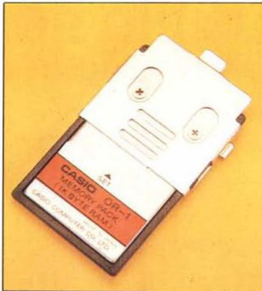
La RAM PACK OR-1 da 1 Kbyte è contenuta in un efficiente package per facilitare il collegamento interno al PB-100.
