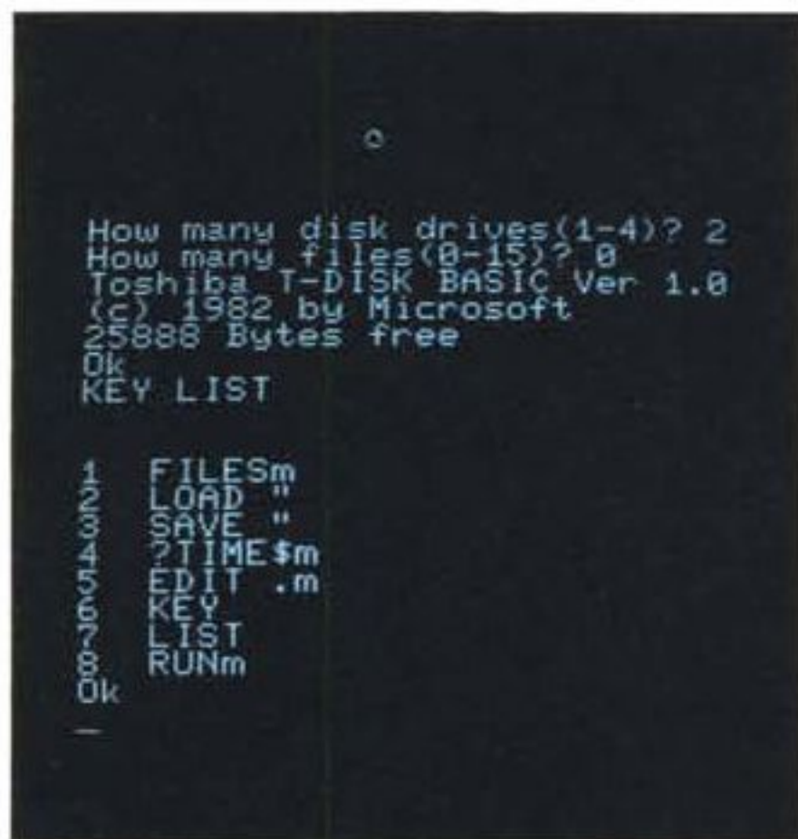
Le tre immagini del video mostrano il prompt del T-BASIC e le definizioni iniziali dei tasti di funzione, il catalogo di un disco, ancora in T-BASIC, ed il direttorio del disco di sistema CP/M, contenente, oltre ai file "standard", alcuni esempi dimostrativi.
