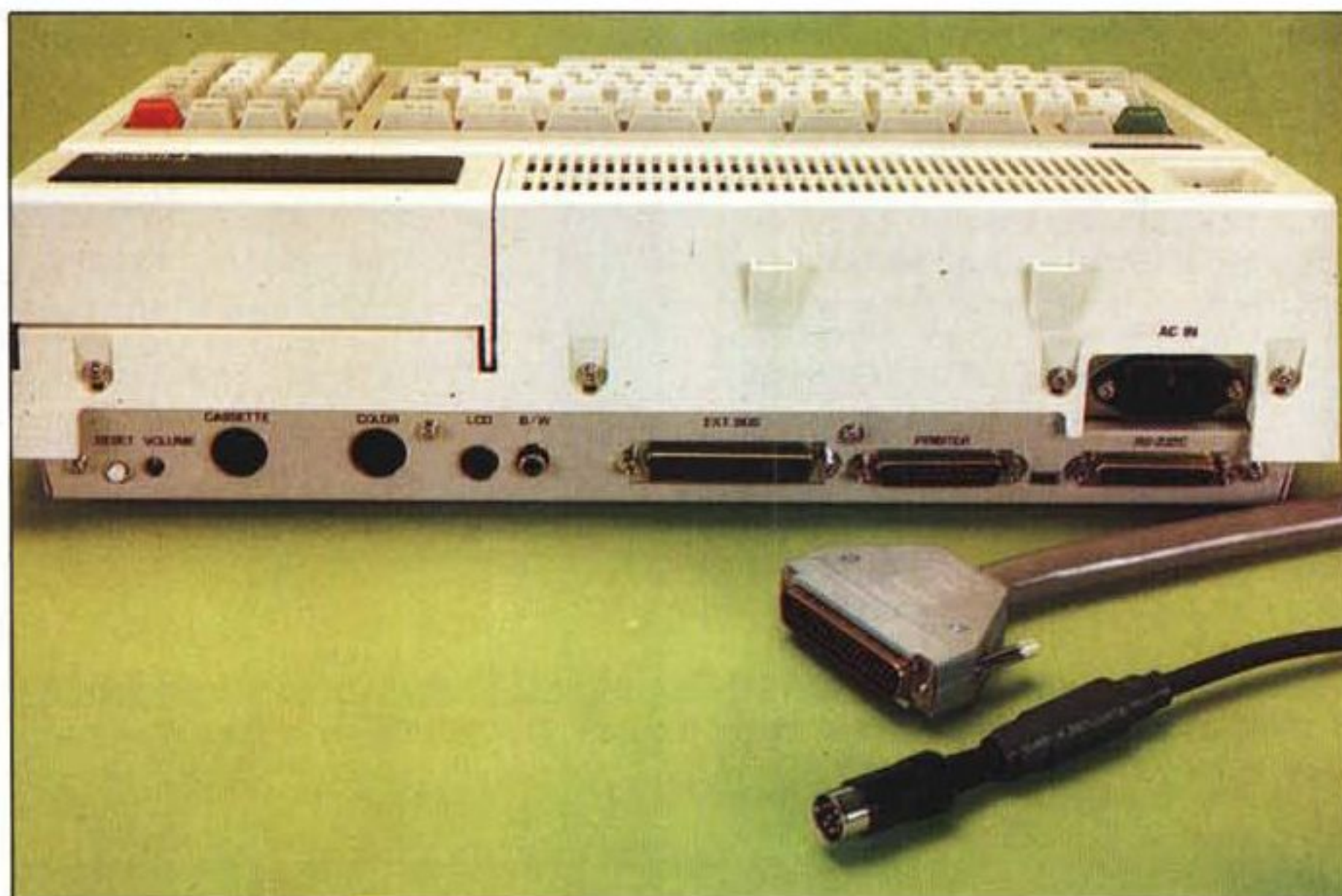
I connettori di ingresso/uscita sono allineati posteriormente. Si riconoscono da destra l'interfaccia parallela per la stampante, le due interfacce seriali, le tre uscite per il video b/n, a colori ed a cristalli liquidi, ed infine quella per il registratore a cassetta.
