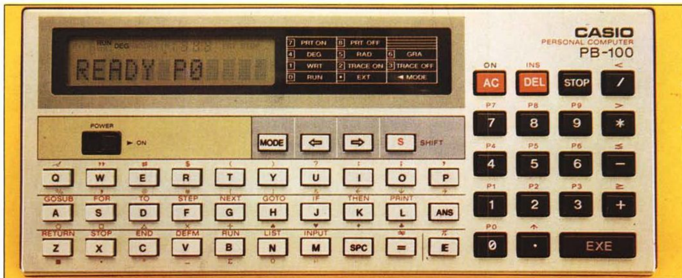
Al momento dell'accensione sul display appare la scritta "READY P0" per indicare che la macchina è pronta ad eseguire il programma P0.
