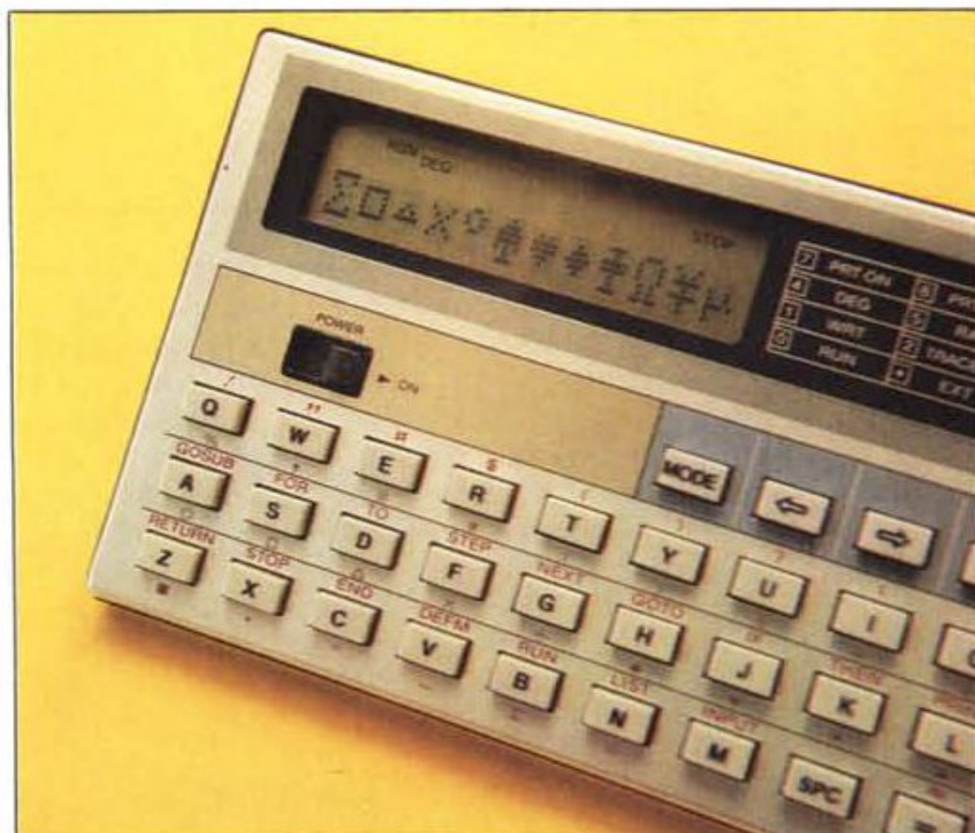
Le foto mostrano due esempi delle possibilità grafiche del display, con un set di caratteri speciali molto esteso.
