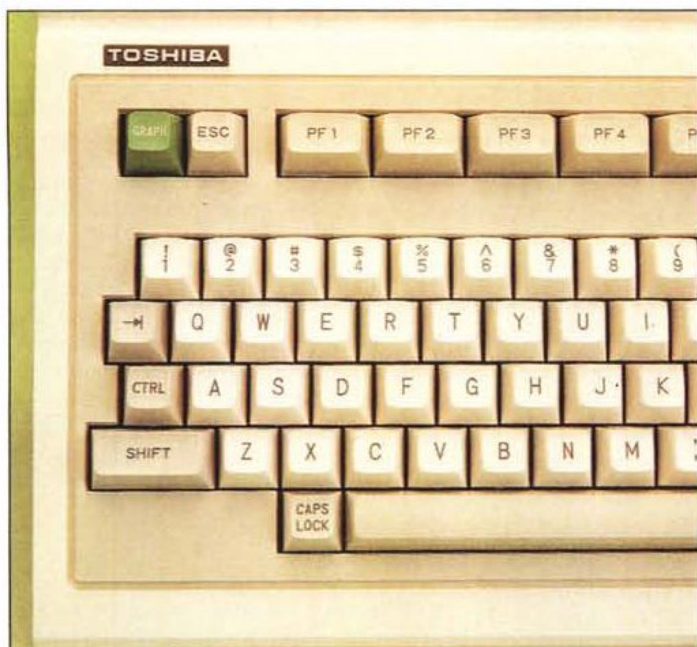
Tra i 97 tasti del T-100 ve ne sono otto utilizzabili per applicazioni speciali, il tutto grazie ad una serie di istruzioni del T-BASIC.
