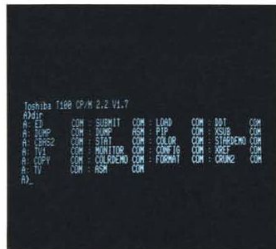
Le tre immagini del video mostrano il prompt del T-BASIC e le definizioni iniziali dei tasti di funzione, il catalogo di un disco, ancora in T-BASIC, ed il direttorio del disco di sistema CP/M, contenente, oltre ai file "standard", alcuni esempi dimostrativi.
